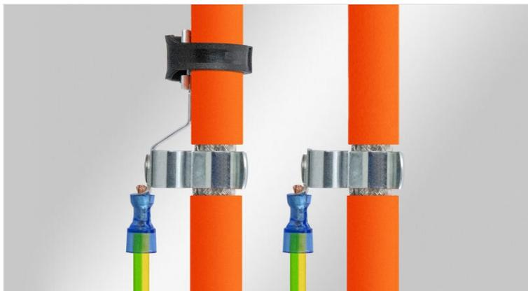
Clips de pantalla de cables EMC montados en terminales de cable con aro. Los clips de pantalla SKL / MSKL son fáciles de utilizar y eficaces en la puesta a tierra de pantallas de cable individuales. El RCL se puede engarzar en conductores PE.
